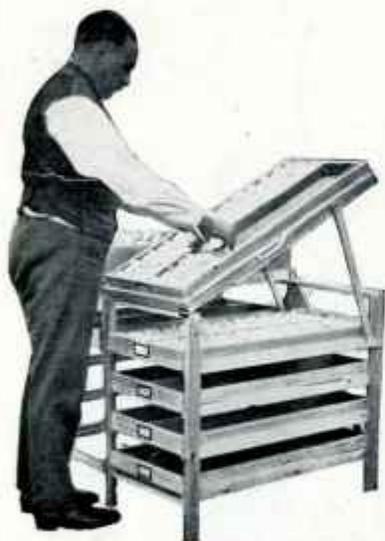
**L'APPAREIL DE RETOURNEMENT** est d'une simplicité extrême. Les œufs sont posés le gros bout au-dessus dans les tiroirs de forme spéciale. Ceux-ci reposent sur 2 pivots, et sont basculés soit à droite, soit à gauche par un simple tour de manivelle. Avec ce système tous les œufs, sans une exception, sont retournés parfaitement et la casse des œufs est absolument impossible.
